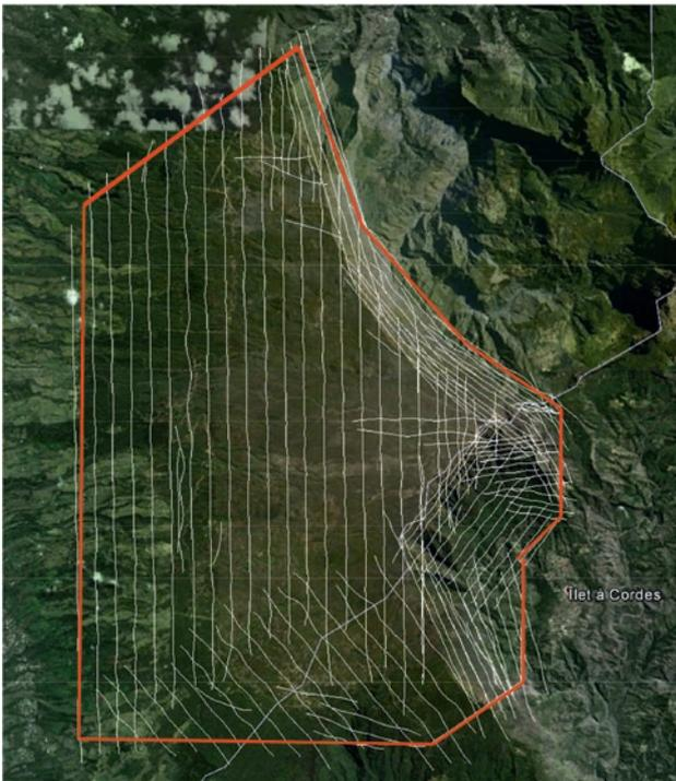
[Fig. 21i]: Plan de survol du lidar sur le Maïdo
